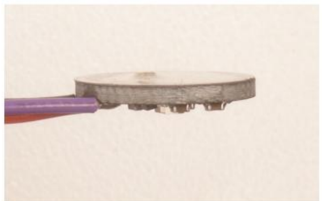
Рис. 2.7. Датчик вимірювання частоти пульсу.
