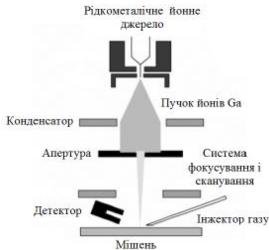
Рис. 6. Схема формування зфокусованого пучка важких йонів низьких енергій в пристроях FIB.
