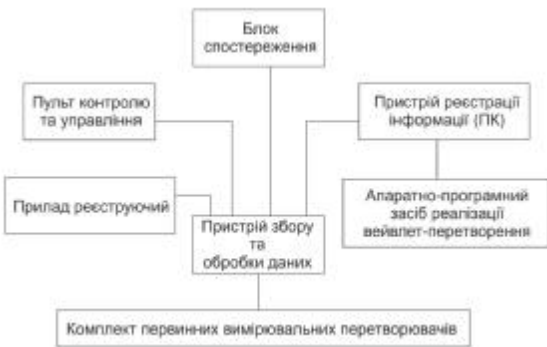
Рис. 1. Структурна схема комплексу СКУБ-М2 з включенням до його складу апаратно-програмним засобом реалізації ТСВП
