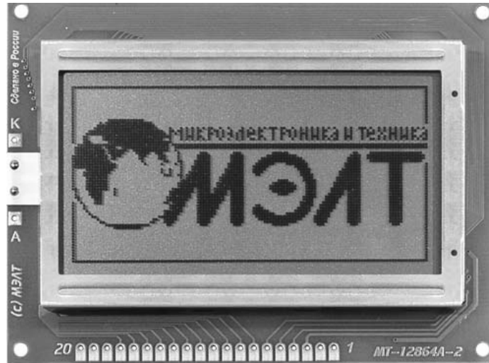
Рисунок 3.6 – Матричний графічний цифровий РК – індикатор, що працює на відображення
