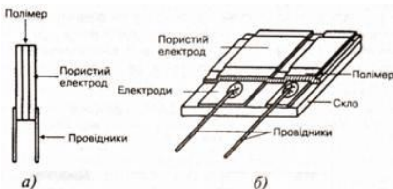
Рисунок 1.4 - Ємнісний гігrometer: а – гігроскопічна полімерна плівка з металевими електродами; б – конструкція гігromетра.
