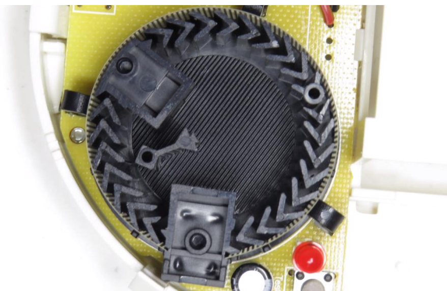
Рис. 1.3. Оптична камера сповіщувача диму.
