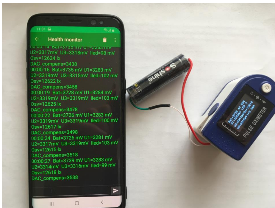
Рис. 3.13. Фотоплетизмограф підключений до застосунку в режимі BLE монітору.
