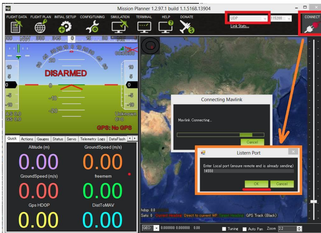
Рисунок 2.5 Перевірка встановлення зв'язку з дроном
