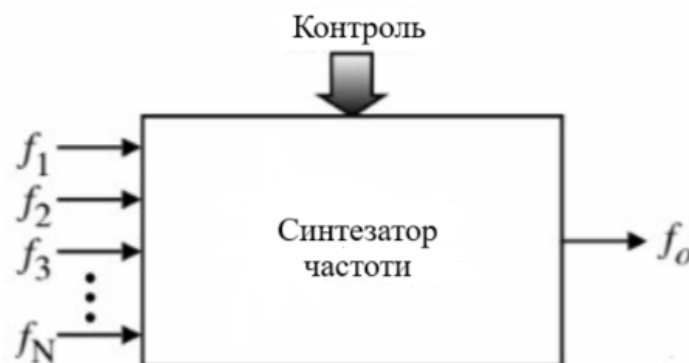
Рис. 1.1 Структурна схема синтезаторів частоти
