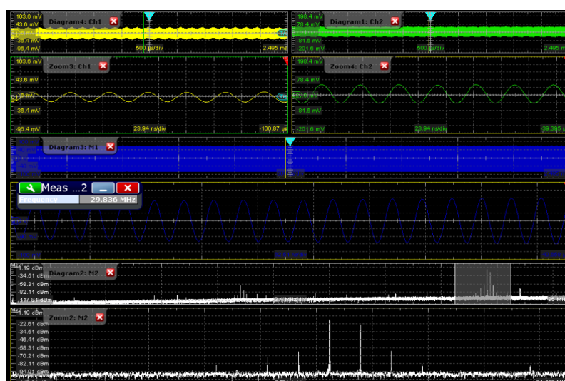
Рис. 4.10 Вихідний сигнал на частоті 30 МГц
