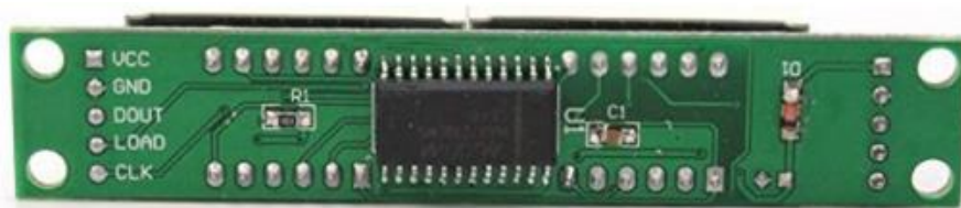
Рис. 4.4 Підключення виводів дисплею MAX7219
