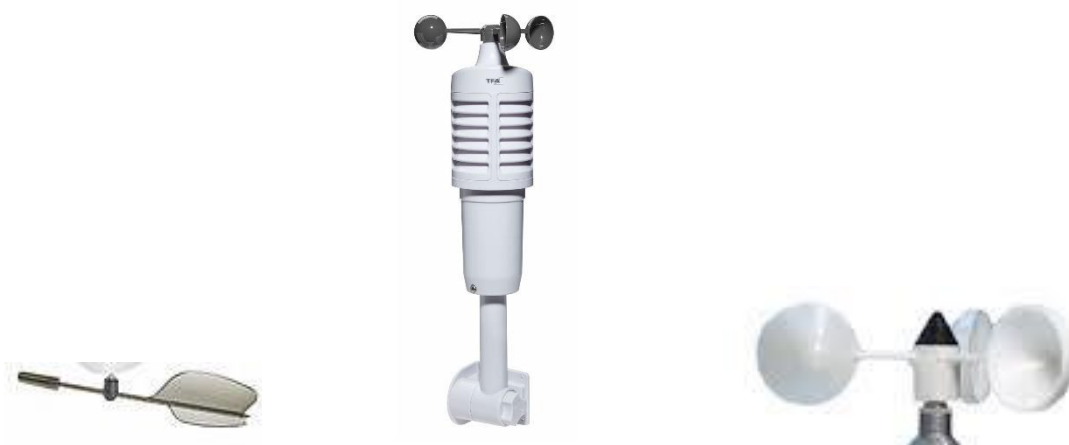
Рис. 1.1 Варіанти конструкції вимірювальних датчиків для мобільної метеостанції.
