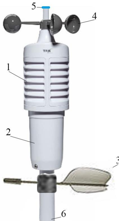
Рис. 2.3. Конструкція компактного давача метеоданих. 1 – жалюзева будка з давачами температури, вологості повітря, атмосферного тиску; 2 – Відсік для електронних компонентів, 3 – флюгер, 4 – чашечковий анемометр, 5 – давач освітленості та магнітометр на телескопічній стійці. Всі проводи протягнуті всередині трубки до якої кріпиться телескопічна щогла.
