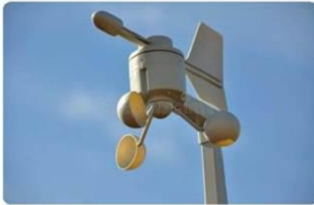
Рис. 1.3. Флюгер і чашковий анемометр.
