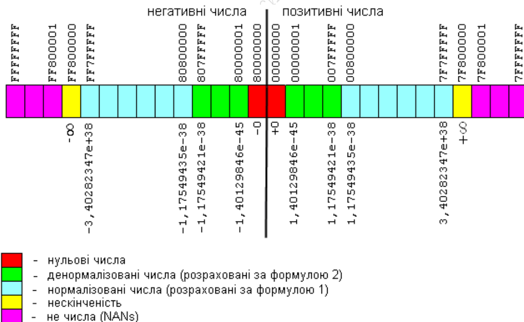
Рисунок 7 – Діапазон чисел формату одинарної точності (32 біти) за стандартом IEEE-754
