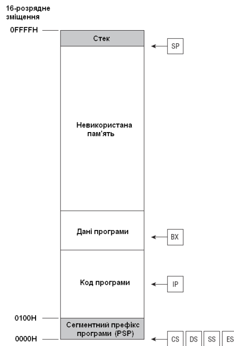
Рисунок 3 – Схема плоскої моделі пам'яті для реального режиму: SP – стек (LIFO буфер), BX – один з регістрів загального призначення, який містить адресу даних, IP – регістр, який містить адресу команди, як буде виконуватися наступною, CS, DS, SS, ES – сегментні регістри, значення яких завантажуються ОС
