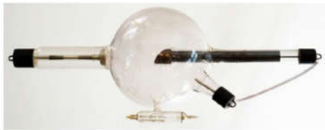
Джерелом рентгенівського випромінювання для РФА є рентгенівські трубки
