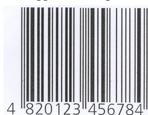
Рис. 4.7. Приклад коду EAN-13
