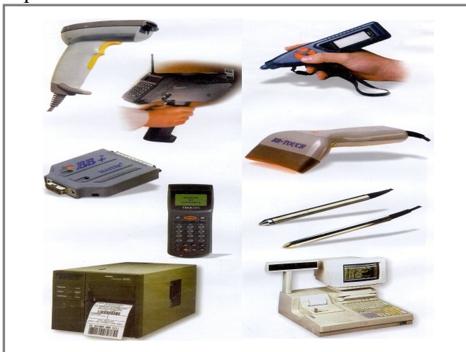
Рис. 4.8. Технічні засоби нанесення та зчитування штрихових кодів
