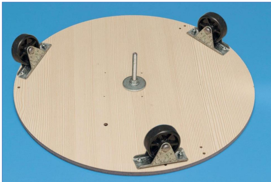
Рис. 1. Один з варіантів зробити поворотний столик – використати меблеві коліщата, розмістивши їх як показано на даному зображенні. Залишається вирізати верхню деталь та просвердлити отвір по центру
