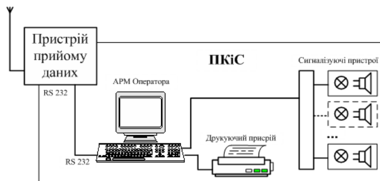
Рис. 2. Структура ПКіС розподіленої комп'ютерної системи
